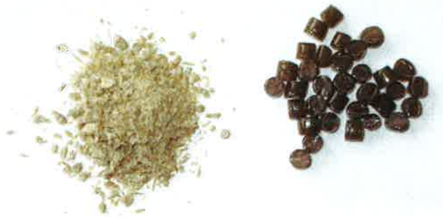
Bild 2. Im CreaSolv-Prozess wird getrocknetes PA 612-Rezyklatpulver gewonnen und daraus ein Regranulat hergestellt
