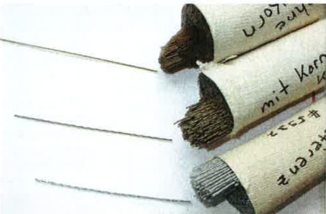
Bild 3. Schleifborsten aus rezykliertem PA 612 im Vergleich zum Referenzprodukt (unten)
